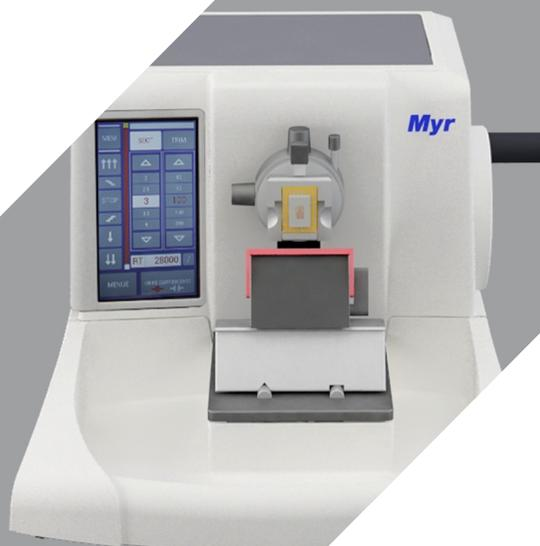
Автоматический фиксатор **держателя лезвия** в основании микротомата (ожидает патентирования) и съемный рычаг для блокировки угла наклона держателя лезвия. Дизайн без рычагов повышает точность и простоту использования. Держатель лезвия может быть расположен с правого или левого края для оптимального использования режущей кромки
